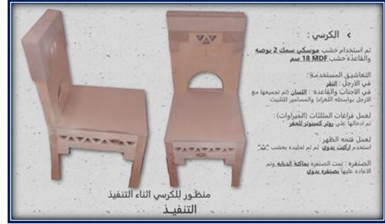
(شكل ٥٤) مراحل تنفيذ الكروسي المستخدم في الكوان الخاص بمنطقة الإستقبال بالفندق خمس نجوم.
